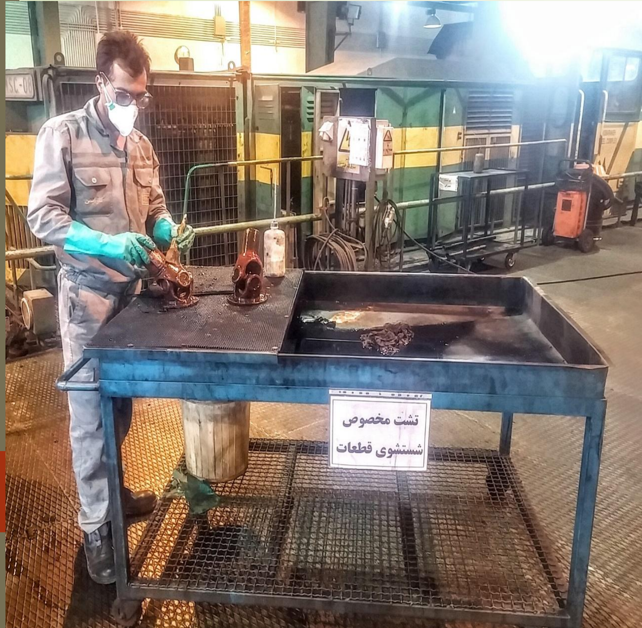
طراحی و ساخت تشت مخصوص با ارتفاع مناسب جهت شستشو
