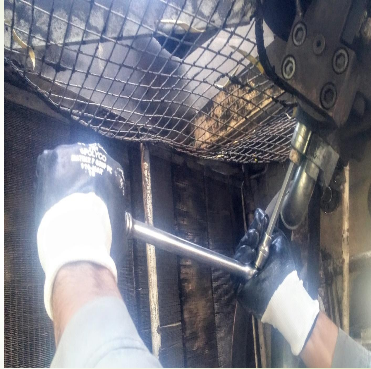
جایگزین کردن آچار با طول دسته بلندتر
