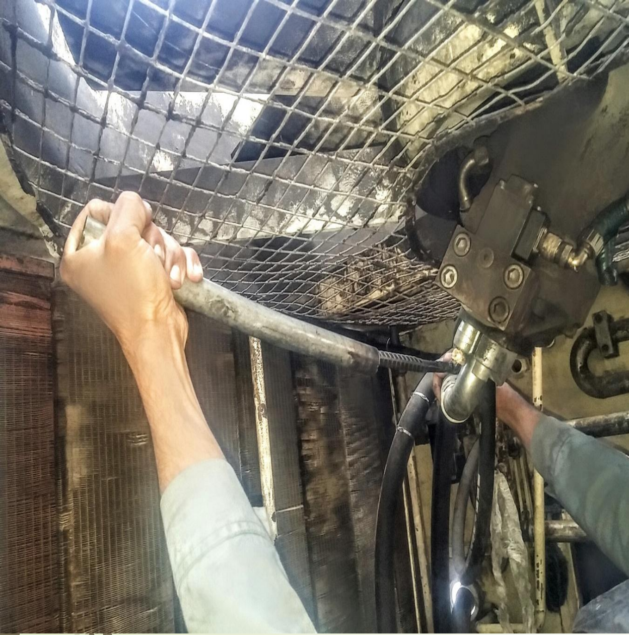
اضافه کردن لوله به دسته آچار (ابزار نامناسب)
