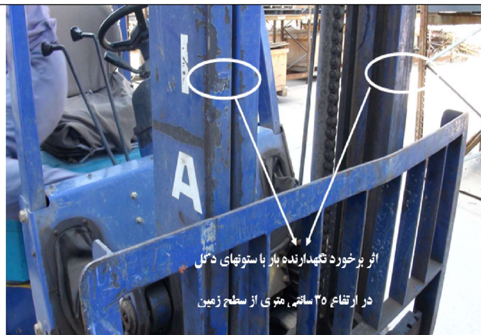
شکل ۳ نمایی از اثر برخورد نگهدارنده بار با ستون های دکل در ارتفاع ۳۰ سانتی متری از سطح زمین
