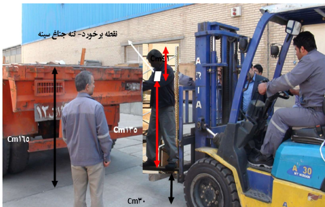
شکل ۶ نقطه برخورد بدن متوفی با لبه کفی تریلی
