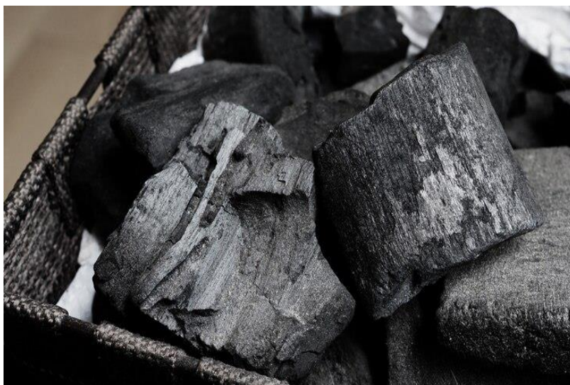
شکل ۹. پودر ذغال به همراه نمک الکتروولیت مناسبی برای چاه ارت می باشد.
